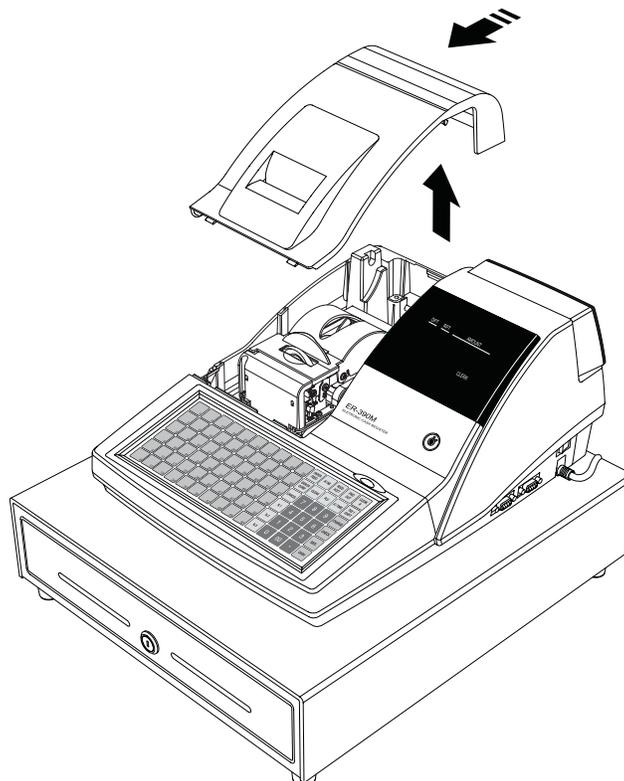
2. Drücken Sie den blauen Hebel nach hinten und öffnen Sie den Druckerdeckel nach oben.
