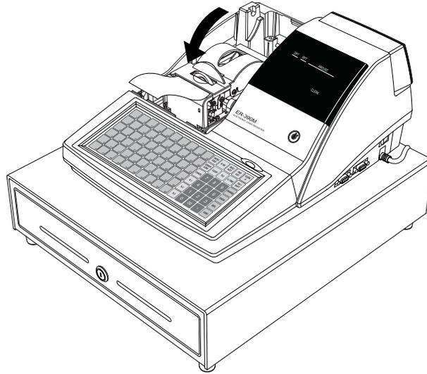
6. Reißen Sie das herausstehende Papier nach vorne an der Druckerseite ab. Schließen Sie die Druckerabdeckung.
